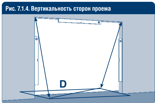
D — стены должны находиться в одной плоскости друг с другом.
